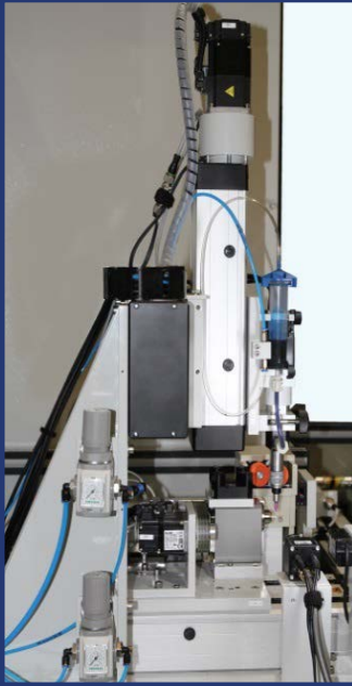
Varnishing unit with four-axes guidance and volumetric dosing system VDS-145 容积漆料加料系统 VDS-145 的四轴引导与容积加料系统
